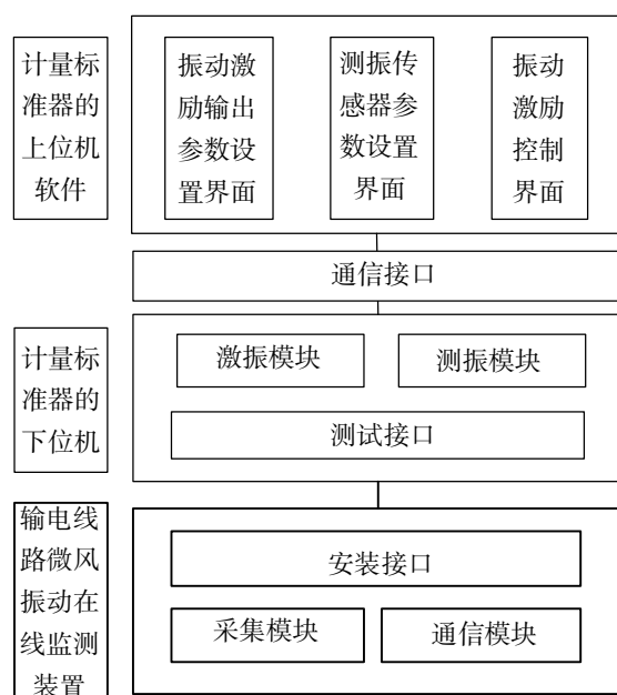
图1 计量标准器的原理图
